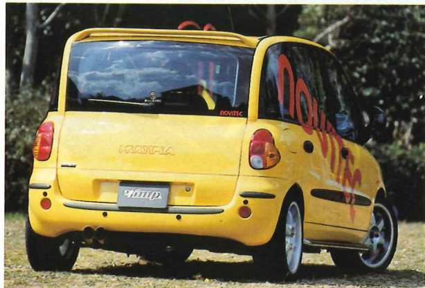
↑ボディサイドにはプロテクトバーが装着されている。何の変哲もないアルミのパイプだが、このマルチプラのキャラクターにマッチしたアイテムなのだ ↑シンプルな造形のルーフスポイラー。ボディの両端から立ち上がるブリッジタイプのデザイン。特徴的なボディデザインに溶け込んでいるので、一見純正か?とも思える
