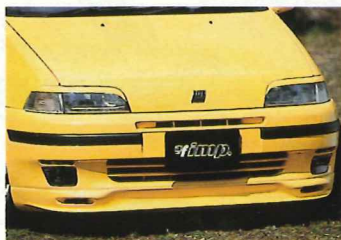
↑ハーフタイプのフロントスポイラー。左右にブレーキターニング用のインテークを配し、実用面でもしっかりと効くエアロになっている
