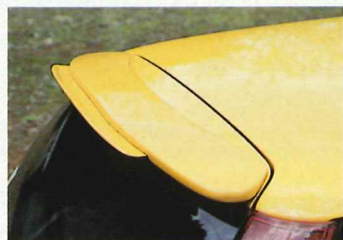
↑センター部の角度調整ができる可変式のルーフスポイラー。視覚上のアクセントにもなるから、アバウトユーザーでなくてもこれは使えるハズ
